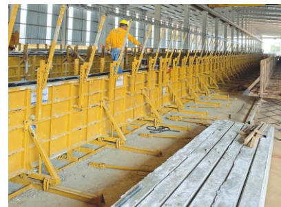
Forma Dupla Regulável para Vigas e Pilares Sistema Deslizante
