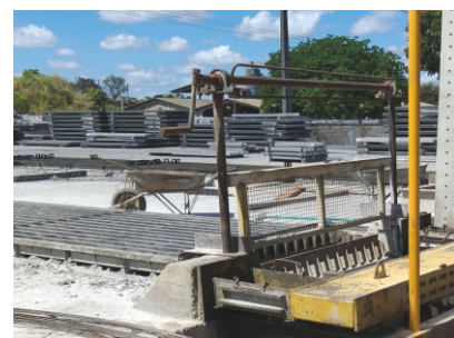
Pista para Fabricação de Estaca Quadrada Seção Fixa
