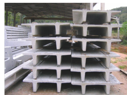
Pista Autoportante para Laje Pi
