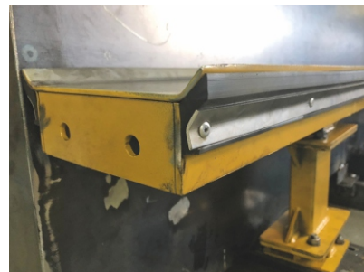
Forma Dupla Regulável para Vigas e Pilares Sistema Deslizante
