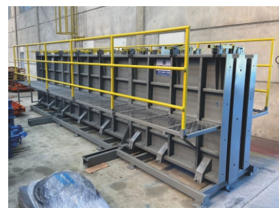
Forma Dupla para Placa de Fechamento Sistema Deslizante
